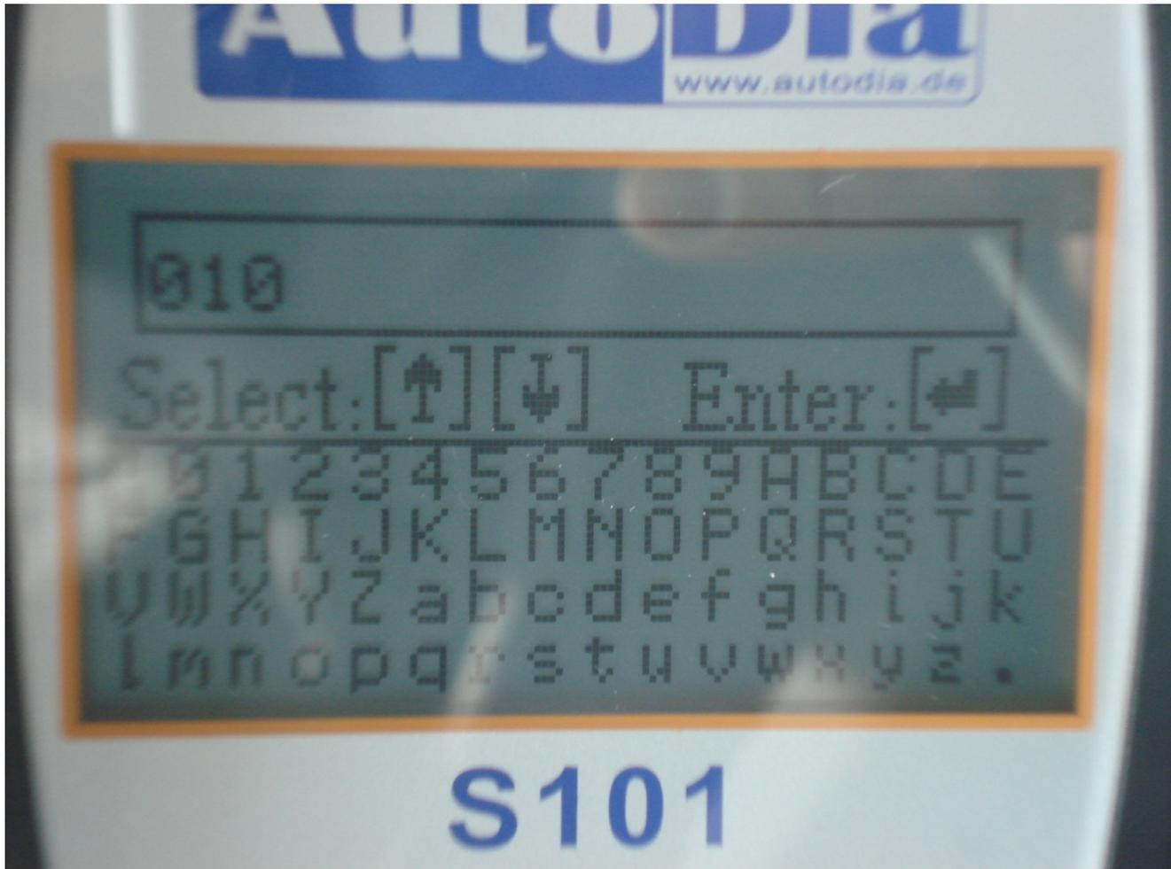
14. Während nach der Bestätigung diese Anzeige im Display erscheint öffnet und schließt die Bremse 3 mal
